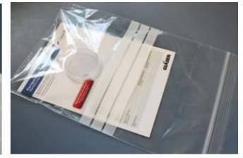
Partikelfalle schließen und saubereitgerecht zur mikroskopischen Analyse transportieren Close particle trap and transport it according to cleanliness requirements to microscopic analysis
